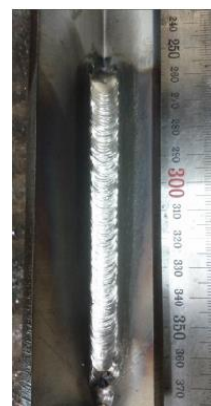
Угловой шов в положении «снизу-вверх»: DC+ 85–95 А
